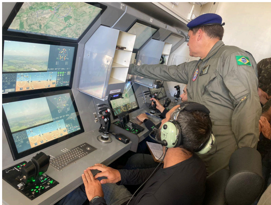
Figura 3 - Estação de controle de solo do Nauru 1000C.
